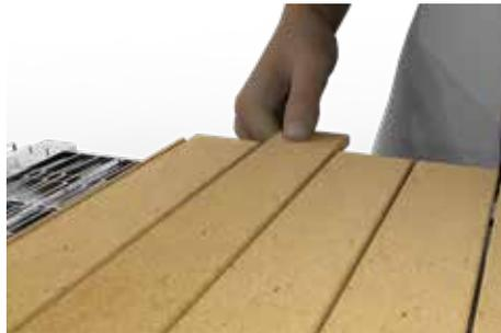
Cinta de piedra dividida cuyas piedras individuales se sustituyen por partes, en caso de ser necesario. La fijación de la piedra se afloja y las losas de piedra individuales se pueden extraer de manera sencilla hacia un lado.
